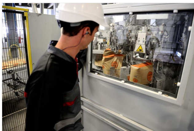
© Gael Kerbaal / INRS Ensachage mécanisé de ciment afin de réduire les émissions de poussières dans une cimenterie
