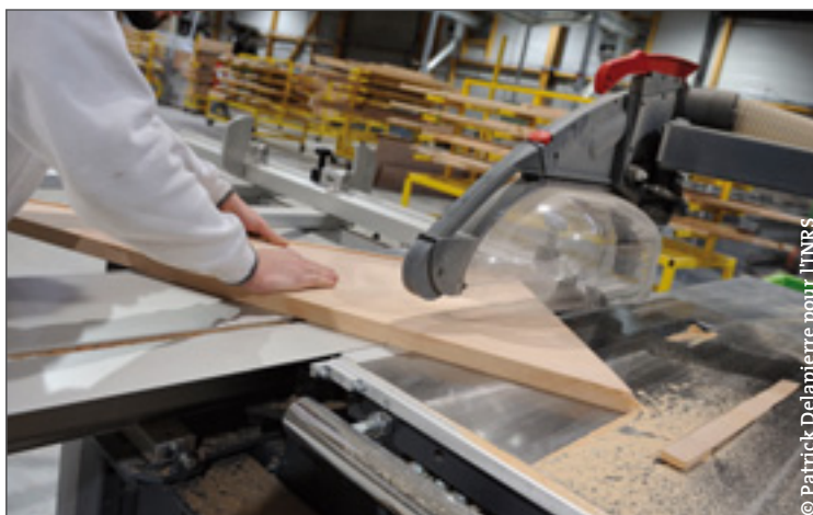
Découpe de planches en bois à l'aide d'une scie circulaire équipée d'une cape de protection aspirante
