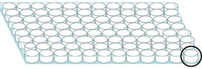
a/ plaque ELISpot 96 puits avec membrane de nitrocellulose
